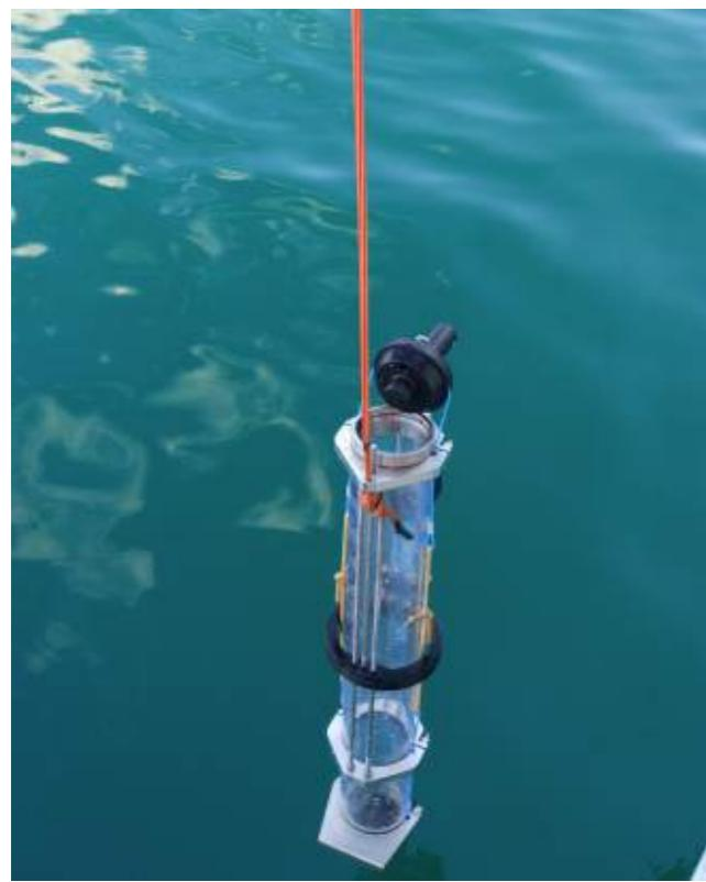
**Предназначен для отбора проб воды на глубинах до 100 м с возможностью размещения датчиков контроля параметров водной среды.**
