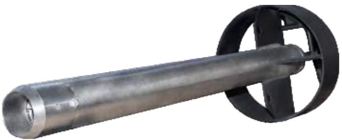
**Предназначена для отбора проб грунта колонкового вида при работе по илистым или глинистым типам донного грунта с судов с использованием маломощных спуско-подъемных устройств.**
