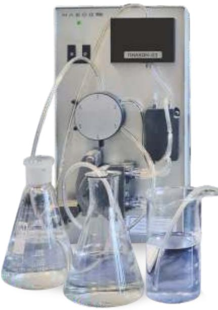
**Анализаторы предназначены для измерения показателей состава химических свойств водной среды, массовой концентрации растворенных нефтепродуктов, пероксида водорода в морской воде.**
