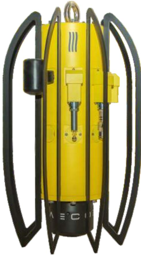
Предназначен для регистрации скорости течений и измерения гидрофизических и гидрохимических характеристик в непрерывном режиме.
