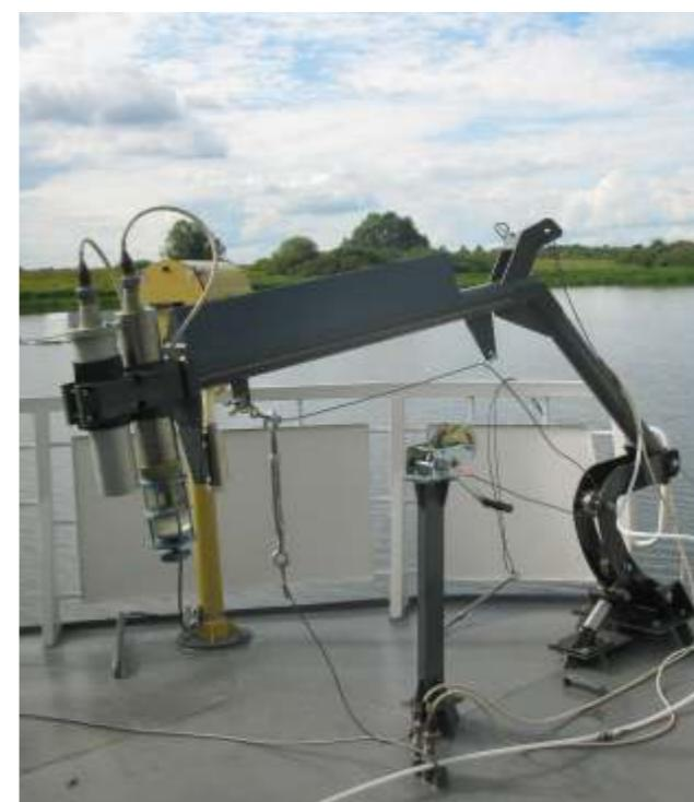
**Предназначено для погружения в приповерхностный слой водной среды измерительной и исследовательской аппаратуры.**
