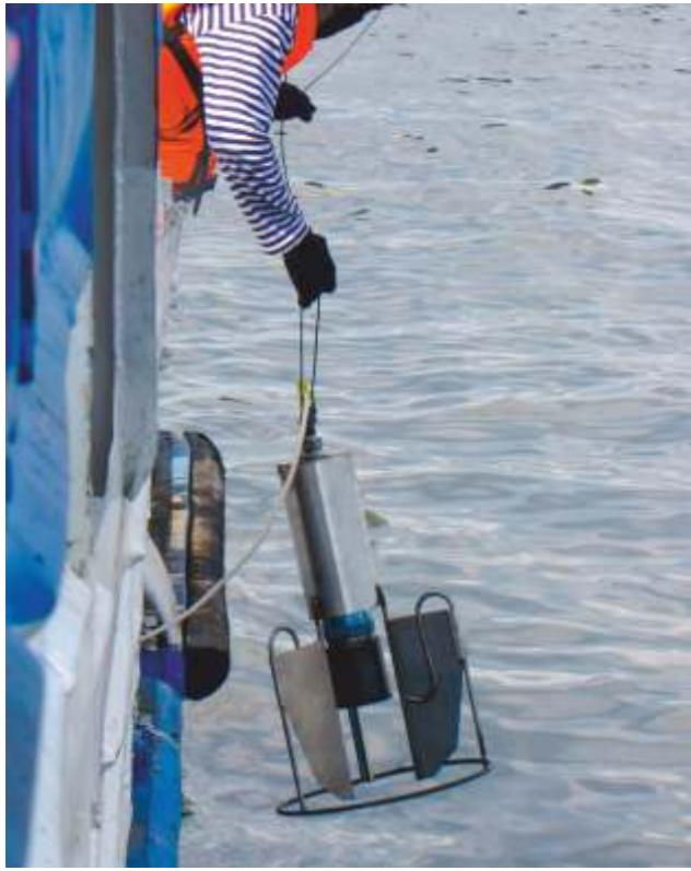
**Предназначена для измерения гидрофизических и гидрохимических параметров при установке на различные носители (буксируемые или самодвижущиеся), при использовании в качестве зонда, или в составе нескольких зондов, при установке на буйковые или донные станции.**
