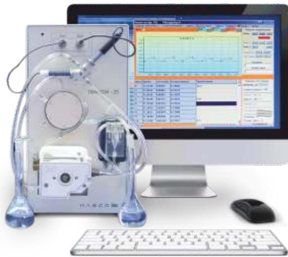
Предназначен для измерения содержания ионов в водных средах.
