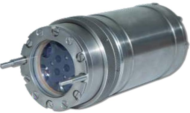
Предназначен для измерения массовой концентрации урана, используемого как трассер, хлорофилла А, растворенных органических веществ и мутности в водной среде на глубинах до 600 м.
