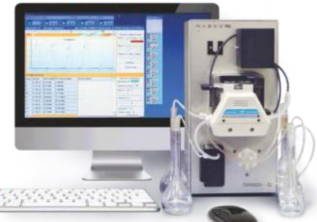
Предназначен для измерений массовой концентрации пероксида водорода в морской воде.
