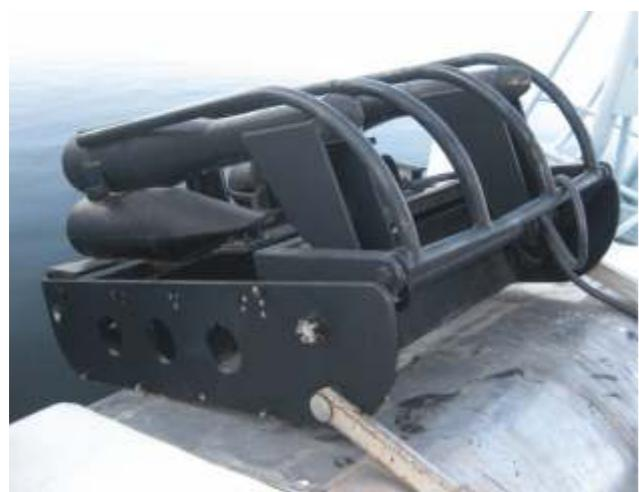
**Предназначен для заглубления комплекта аппаратуры и стабилизации движения путем буксировки.**
