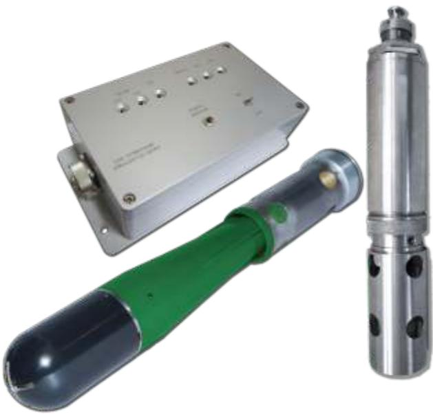
**Предназначена для измерения температуры, удельной электропроводимости, гидростатического давления, солености, плотности и скорости звука в морской воде с помощью одноразовых обрывных зондов.**
